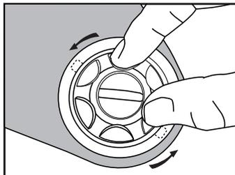
3. 点線部分の凸部分を引き込んだ状態で、シールドを矢印の方向に押すとシールドを取り外せます。
