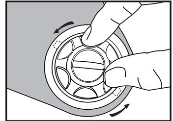
3. カチッと音が鳴り固定できたら矢印の方向にダイヤルを回しシールドを下げて、取り付け完了です。
