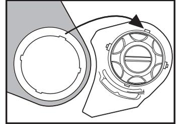
2. 凸と凹が一致したらダイヤルを矢印の方向に回しながらカチッと音が鳴るまでシールドをシールドダイヤルに押し込み固定します。
