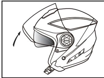
2. シールドダイヤルを右図矢印の方向にまわしてください。点線部分の凸部分が内側に引き込まれます。
