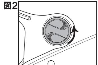
シールドビスを指でつまみ図1、図2の矢印の方向に90°回転させ、左右のビスを外してシールドを取り外します。
