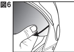
シールドを上げた状態でインナーシールド操作レバーを図5の矢印の方向にカチッというまで回して、インナースモークシールドをおろして下さい。次に図6の矢印の方向(斜下)に引きはずして下さい。反対側も同じ様に引きはずして下さい。
